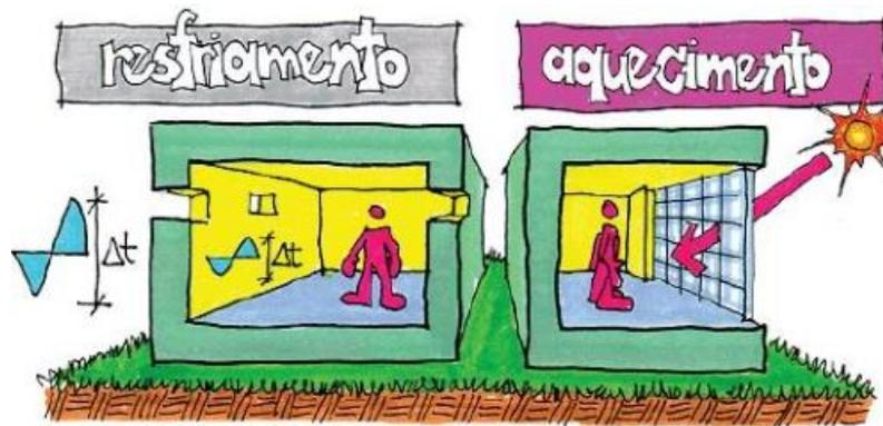
Figura 56 - Ilustração da aplicação da inércia térmica. Fonte: Lamberts et al., 2014.
