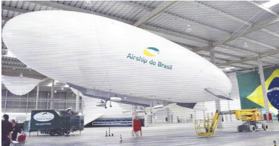
Figura 4: Protótipo dirigível cargueiro ADB 3-30
